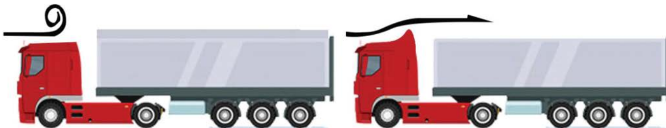
حالت جریان هوا بدون بادگیر
